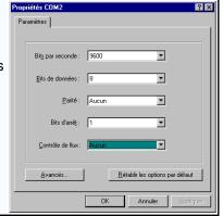
6 Le PC est en mode terminal, le relier à l'appareil en branchant le cordon RS232. La mesure est visualisée à l'écran. Pour entrée en configuration, taper sur "C" au clavier.
